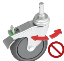
Pengunci Swivel mengubah kastor hidup menjadi kastor tetap, sehingga mudah dioperasikan oleh satu orang. (Kastor tipe TPRJB)
